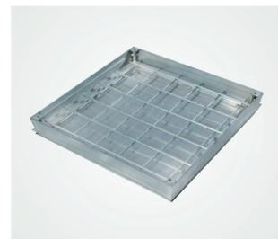
La versione "termica", è dotata di pannelli isolanti composti da schiuma poliuretanic rigida con rivestimento in alluminio su due lati dello spessore di 80 mm. Questa è fissata all'interno di un telaio angolare e può essere inserita facilmente nella struttura dopo il montaggio.
